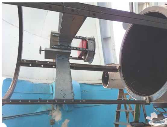
Рис. 5. ПЗЗ-камера Atik Infinity в первинному фокусі телескопа АЗТ-14
